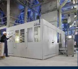
INTEGRA® et miniseal® – ensacheuses automatiques pour sacs à valve (5 kg) avec fermeture ultrasonique de la valve, 1 - 4 bacs
