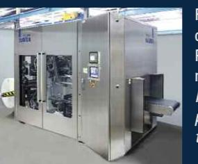
FFS – FORM FILL SEAL – Système de remplissage en sacs en gaine PE, en option avec changeur automatique de bobine
