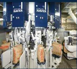
ROTOCLASSIC® à 3 - 16 bacs d'ensachage, système de remplissage par turbine ou par fluidisation
