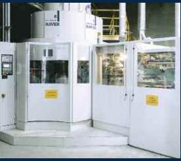
ENSACHEUSE ROTOSEAL® Modèle sur sol avec fermeture ultrasonique de la valve et applicateur automatique
