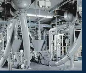
Silo à plusieurs compartiments – pour stockage de composants, avec mélangeur intégré pour fabrication de ciments spéciaux
