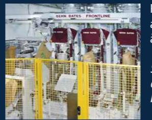
Poste d'ensachage entièrement automatique pour sacs à valve, à 1 - 4 bacs d'ensachage
