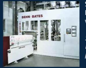
Système d'ensachage „Plug & Pack“ INTEGRA® FD pour sacs à valve
