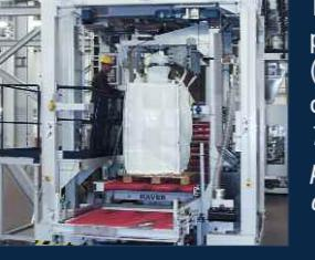
Technique d'ensachage Semi Bulk pour sacs à grande contenance (FIBC), conteneurs octogonaux, cartons et autres emballages
